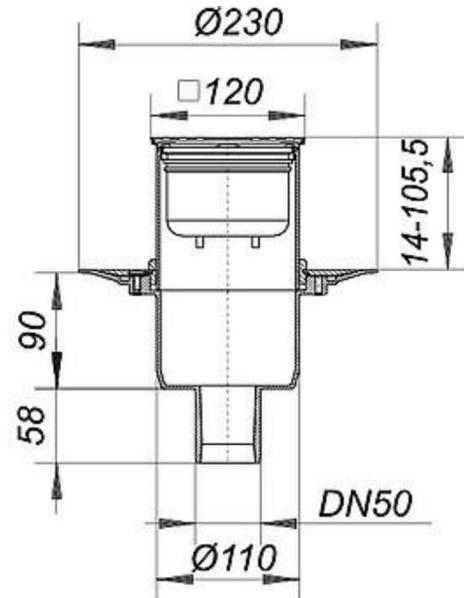
**Sumidero DALLMER 30 modelo PRIMUS E12** fabricado en Polipropileno con sifón mixto en seco e hidráulico compuesto de:
