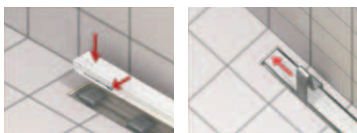
Instalación de la rejilla lineal antirrobo
